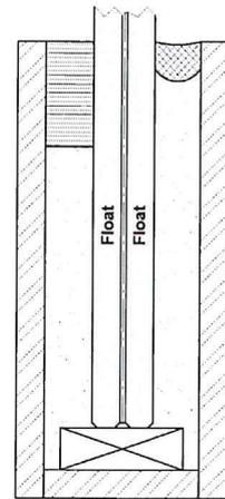
**Gegenstand:** An der unteren Kante linienförmig eingespannte, absturzsichernde gebogene Brüstungsverglasung aus VSG aus Float nach DIN 18008-4, deren Tragfähigkeit unter stoßartigen Einwirkungen experimentell nachgewiesen werden soll.
